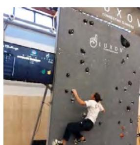
Luxov Touch est un système unique de prises d'escalades connectées à détection de toucher. Il permet au grimpeur d'avoir un suivi détaillé de ses performances en connaissant de manière exacte le moment où il a saisi la prise et sa durée de préhension. Cette technologie permet ainsi une mesure objective des performances avec une précision supérieure au centième de seconde, quelle que soit la taille, la forme ou l'endroit touché de la prise. **Catégorie équipement collectif**
