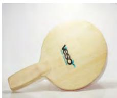
Ecoping est une raquette de tennis de table personnalisable à destination des pongistes confirmés et des professionnels. Ecoping se compose de fibres naturelles comme le bambou, d'une âme alvéolaire et d'une masselotte contenue dans l'âme. Lors de sa fabrication, la raquette est réalisée de façon à s'adapter au jeu du pongiste. La masselotte, qui modifie le centre de gravité de la raquette, sera placée selon les besoins du client. **Catégorie technologie**
