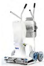
PEPS 200 est un robot de nettoyage automatique doté d'une intelligence artificielle. Equipé d'un système infra rouge pour la détection des murs et d'un gyroscope pour le déplacement, le robot aspirateur assure un nettoyage optimal des fonds des piscines. Cet outil est compatible avec l'ensemble des piscines de 25 mètres ou moins quel que soit le revêtement au sol (carrelage, béton, inox ou liner). **Catégorie technologie**
