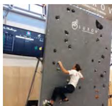
Luxov Touch est un système unique de prises d'escalades connectées à détection de toucher. Il permet au grimpeur d'avoir un suivi détaillé de ses performances en connaissant de manière exacte le moment où il a saisi la prise et sa durée de préhension. Cette technologie permet ainsi une mesure objective des performances avec une précision supérieure au centième de seconde, quelle que soit la taille, la forme ou l'endroit touché de la prise. **Catégorie équipement collectif**
